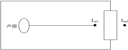
图 6.4-1 室内声源等效为室外声源图例
