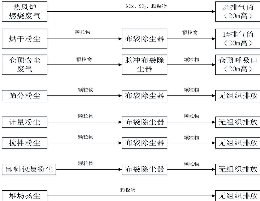
图 7-1 本项目废气流程图
